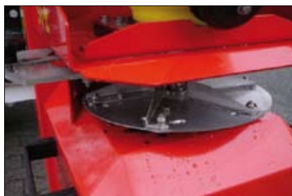
Streuscheibe mit zentraler Streuflügelverstellung
