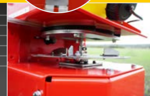
Streuweiten bis zu 21 m, regelbar über Drehzahl. Detail: Dosiereinrichtung zur Einstellung der Streumenge
